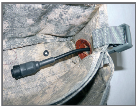
a - Passer la fiche mâle du cordon spiralé de 1,5 m (MBA-8205) à travers l'ouverture prévue à cet effet sur la sacoche.
